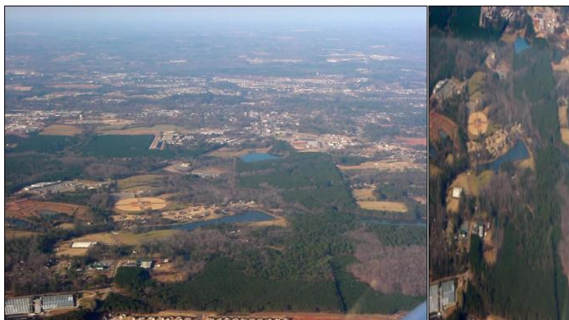
Z lewej - zdjęcie lotnicze. Z prawej zdjęcie to po ortorektyfikacji
